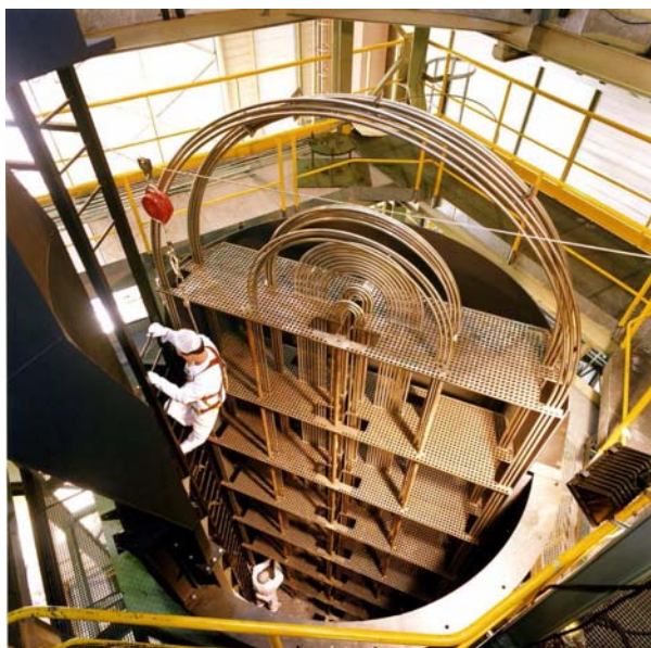
Montage des tubes à l'intérieur du générateur de vapeur à l'usine de fabrication (Areva)
